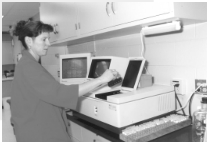
Техник вставляет образец со спермой в спектрофотометр.
